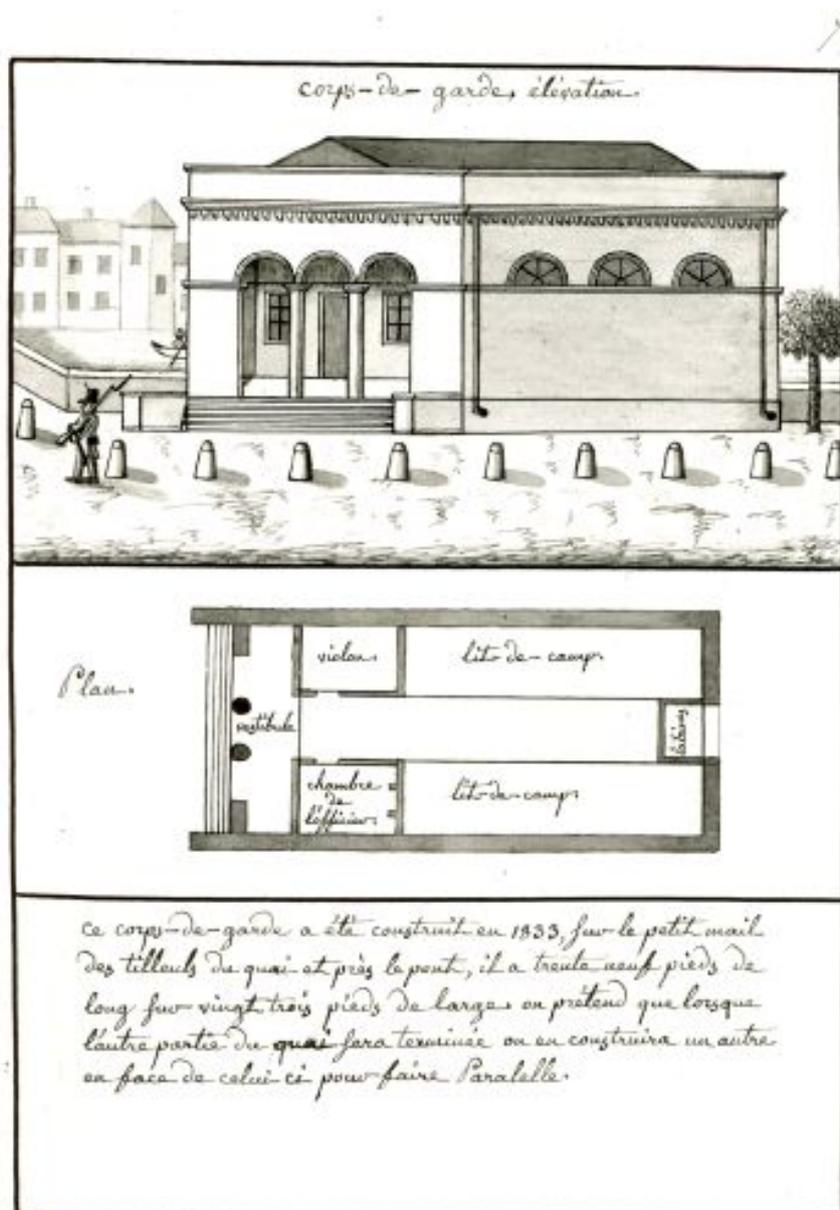
Corps de garde : élévation, plan, par J.-A. Berthe, après 1833.
