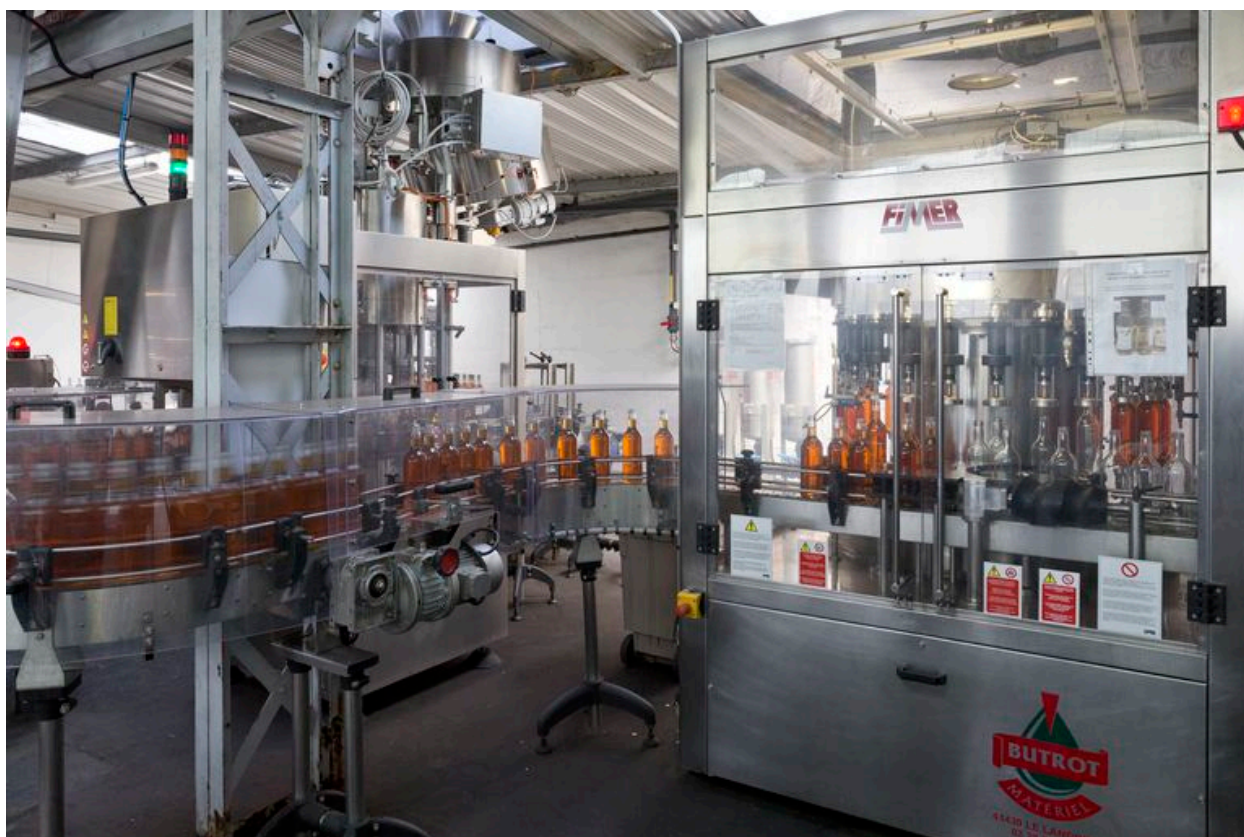
20 boulevard de Cardiff : Ligne verre, remplissage.
