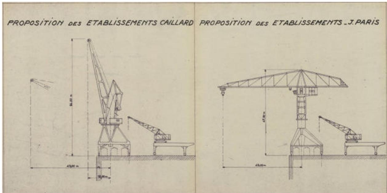
Comparaison des propositions faites par les Etablissements Caillard et Joseph Paris pour répondre à la commande d'une grue de 60 tonnes.
