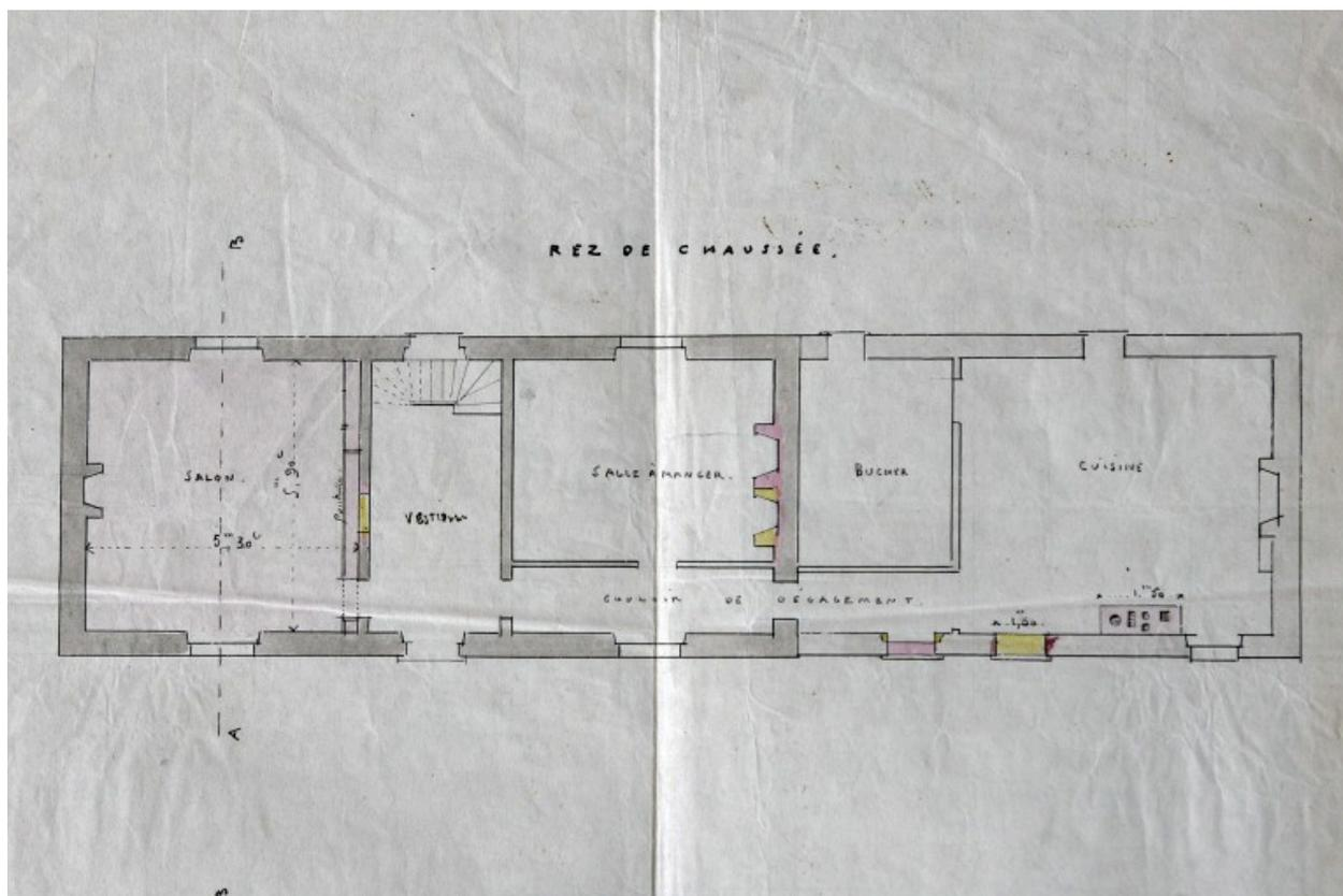
Presbytère de Jauzé à réparer, feuille 1, détail : plan du rez-de-chaussée montrant notamment le couloir gagné sur la salle à manger vers 1838.
