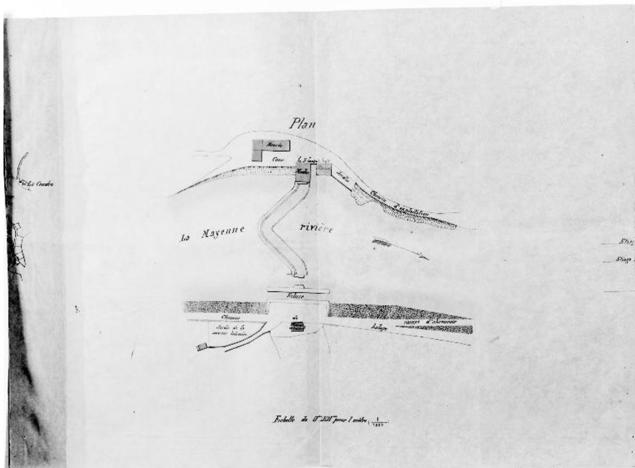
Plan d'ensemble du site après la construction du barrage à écluse et du moulin.
