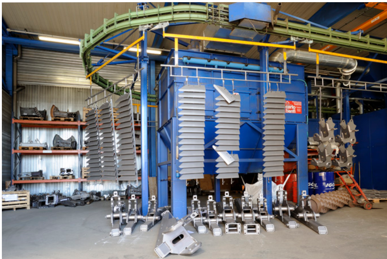
Usine Grégoire-Besson : atelier pour le grenailage.
