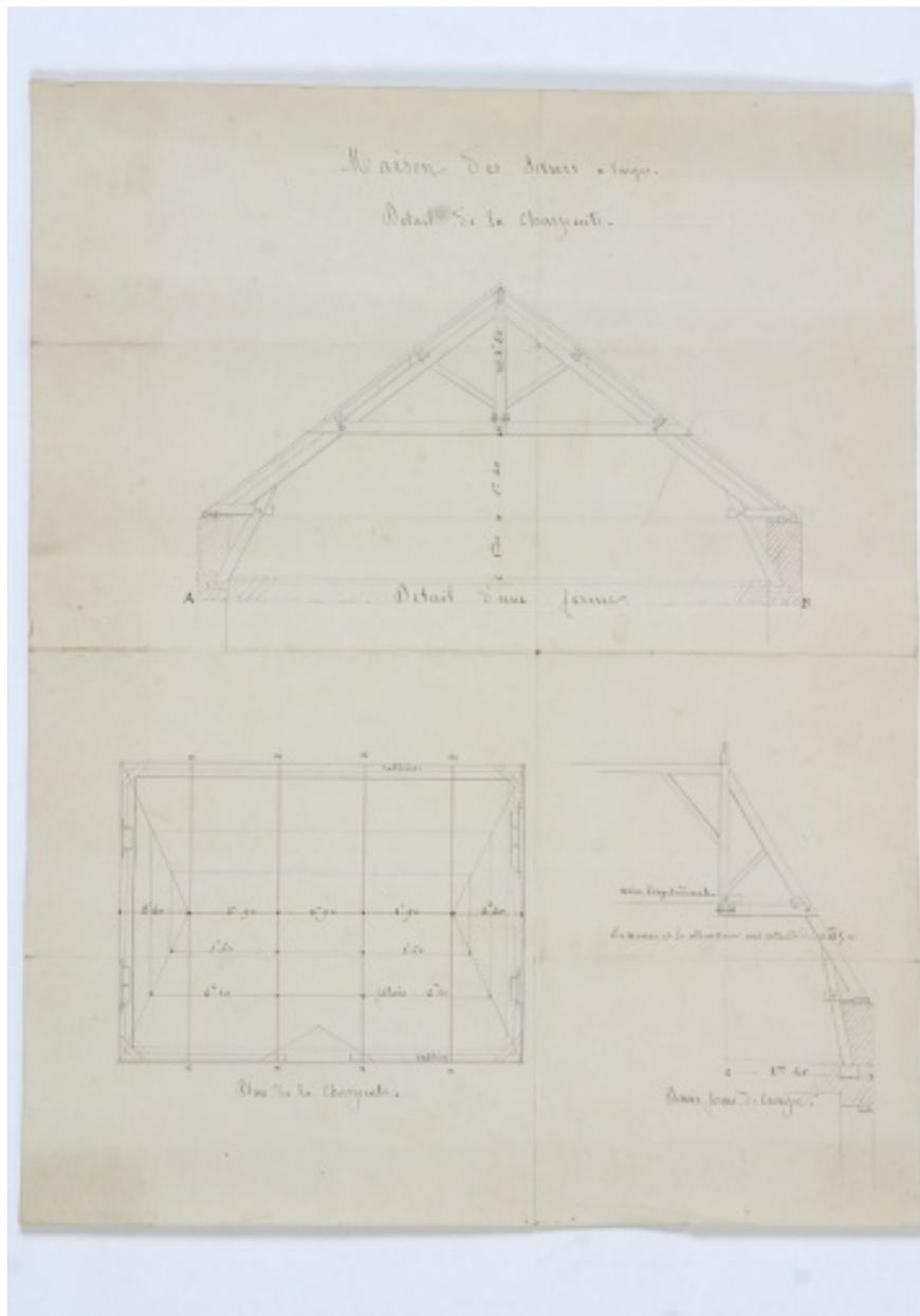
Projet de construction d'une maison pour les soeurs de Vaiges. Charpente : plan, ferme, demi-ferme de croupe, vers 1874.
