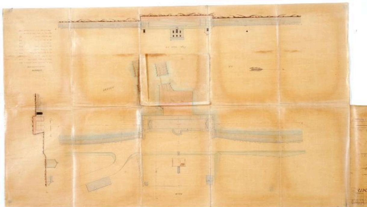
Projet de canalisation de la Mayenne entre Formusson et Pendu. Plan, coupe transversale et coupe longitudinale de l'écluse de la Bavouze.
