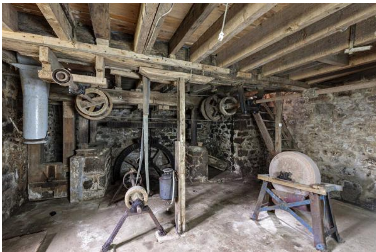
Soubassement, roues et arbres de transmission.
