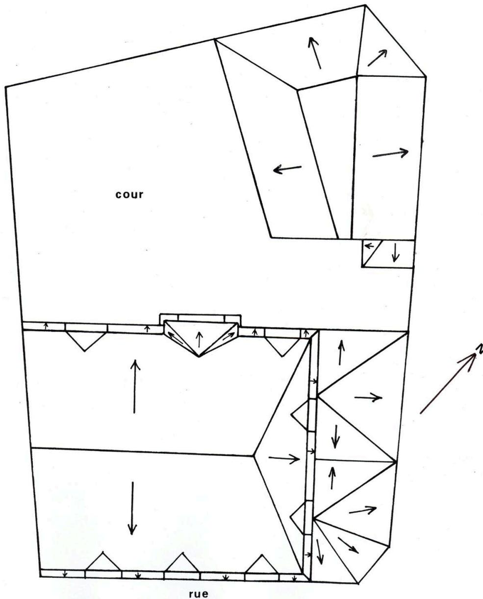
Plan schématique des couvertures.
