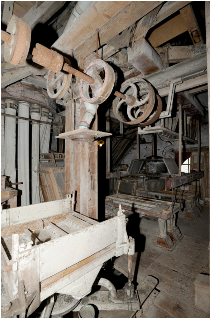
Plansichters situés au troisième étage.
