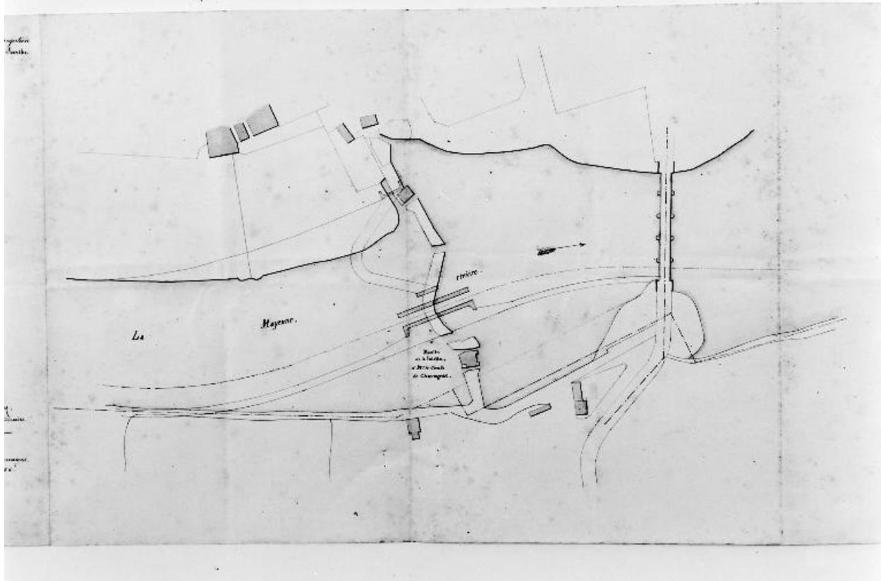
Projet (non réalisé) de construction d'un barrage à écluse en remplacement de l'ancienne chaussée : plan d'ensemble du site.
