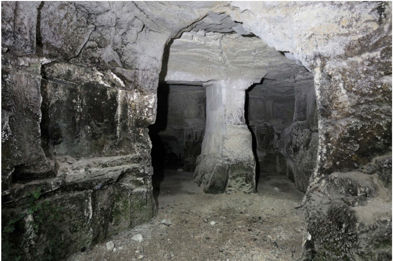
Carrières de Chaumont, exploitation par pilier tourné, en trois tranches d'extractions superposées.
