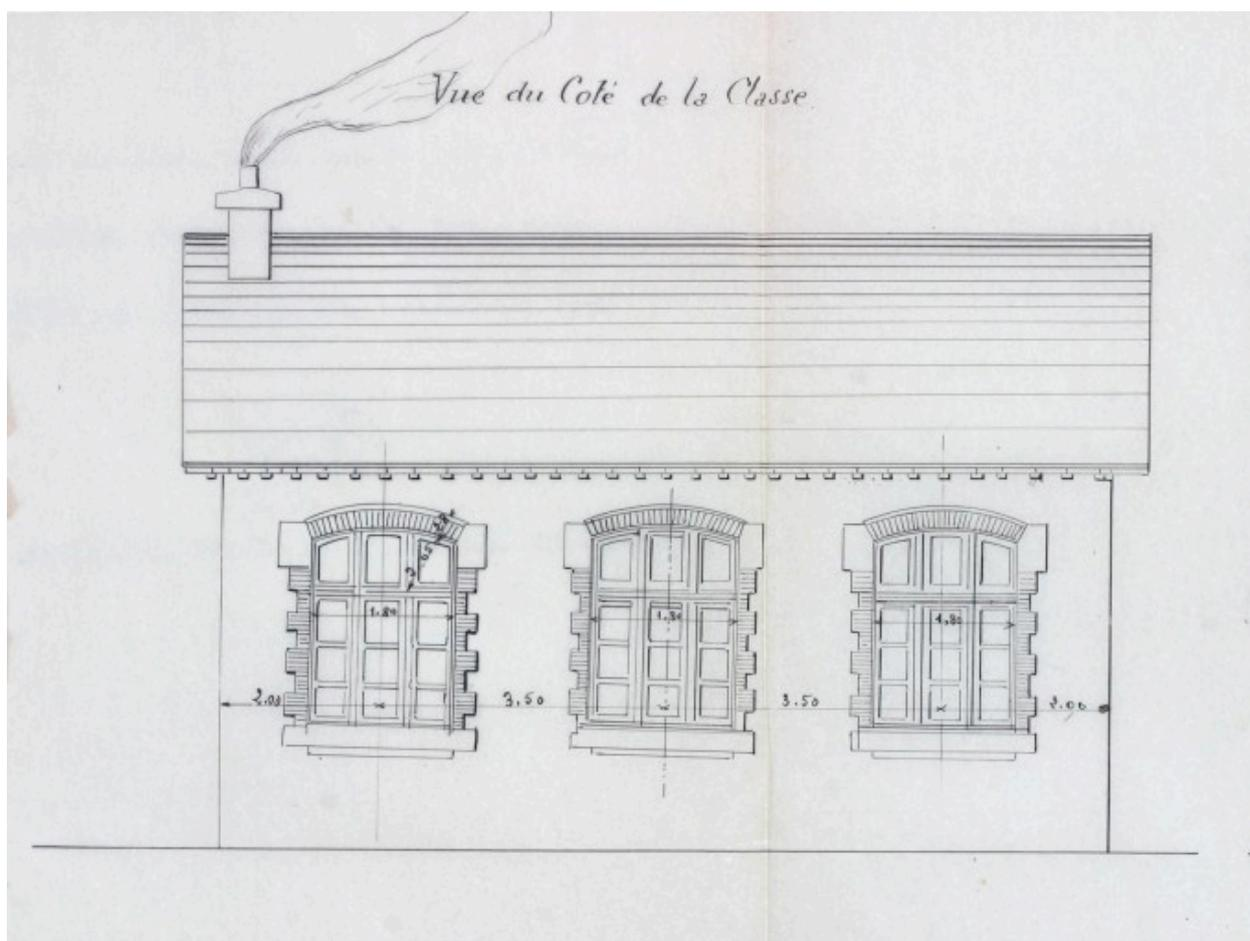
Construction d'une classe mixte, de water-closets et de préaux pour l'école primaire ; plans, élévations et coupes de la classe et du préau. Détail : élévation nord de la classe.
