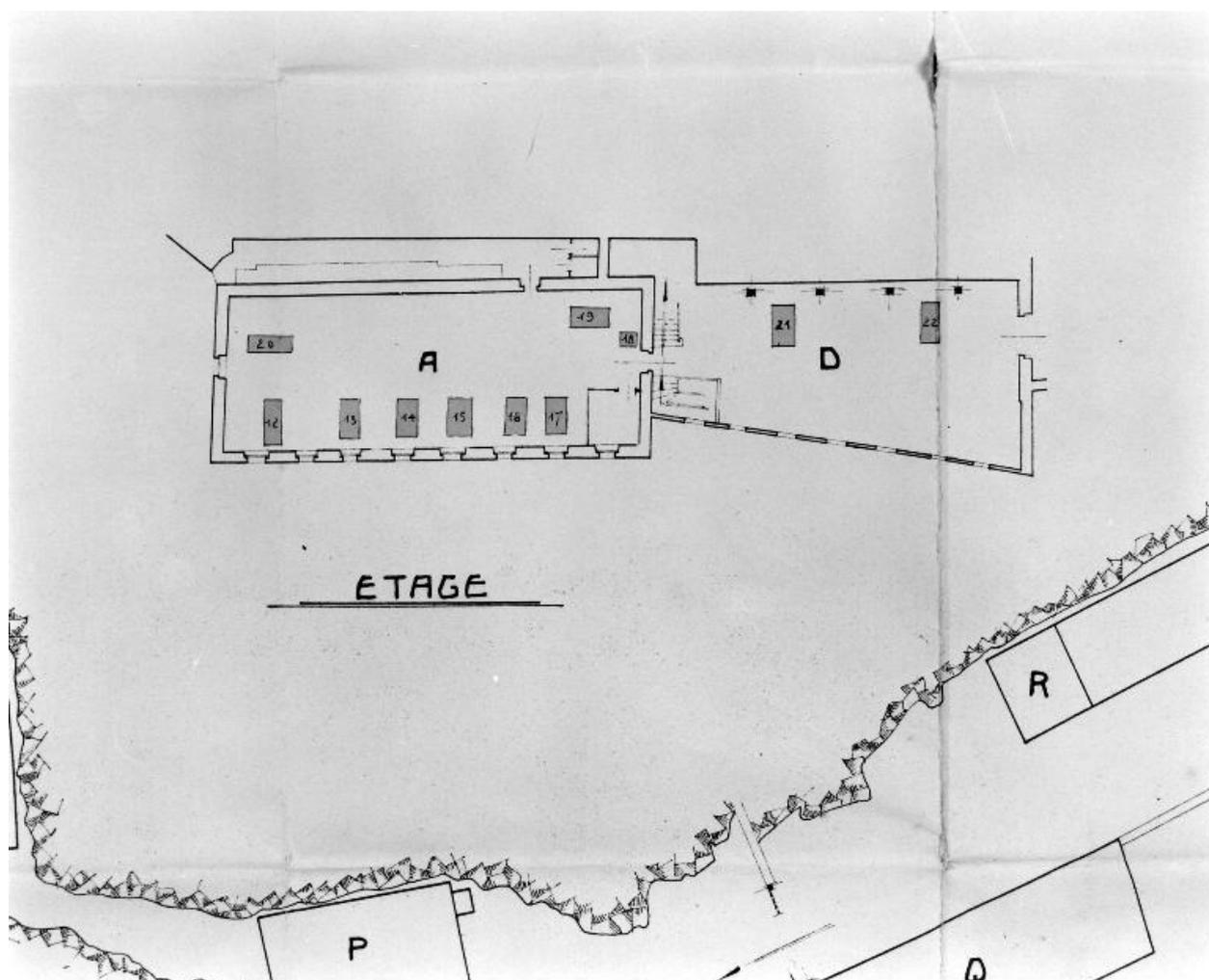
Extrait du plan de l'usine néo-métallurgique et de ses dépendances : plan du premier étage des bâtiments abritant les ateliers de fabrication des métaux.
