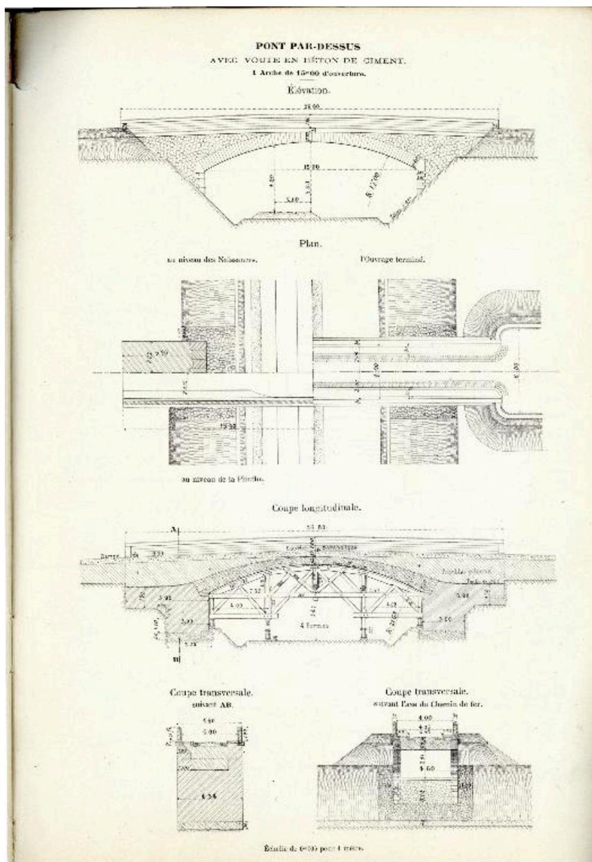
Plan, élévation et coupes de pont-route en voûte de béton de ciment, 1877.
