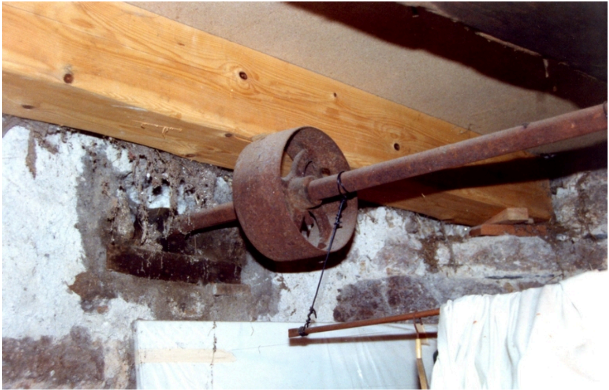
Arbre de transmission horizontal du mouvement rotatif du moteur auxiliaire extérieur vers le gros-fer. Josick Lancien, septembre 1990.
