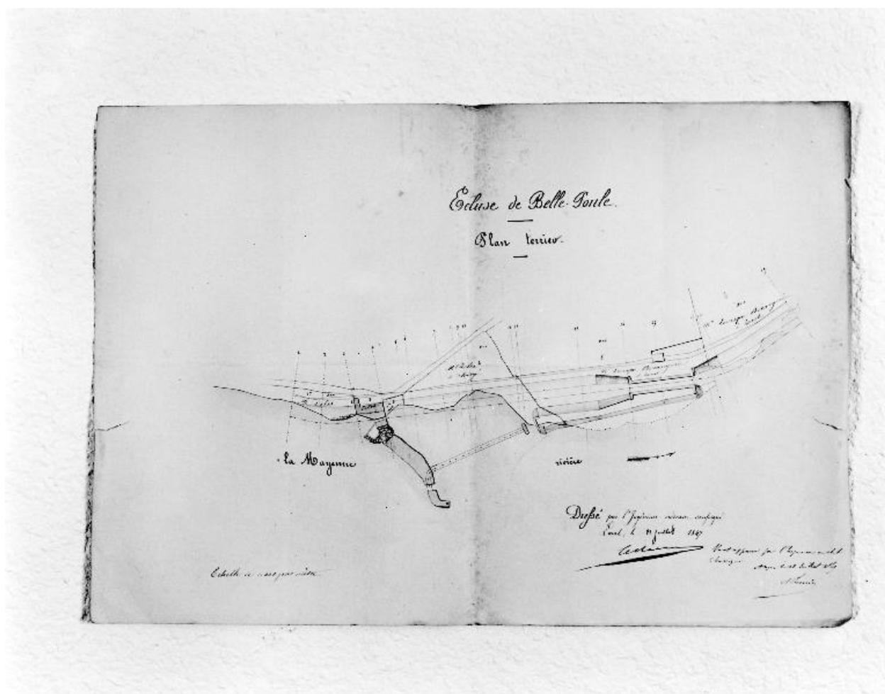
Premier projet. Plan d'ensemble : ancienne chaussée et moulin rive gauche (détruits), barrage, pertuis, canal et écluse projetés.
