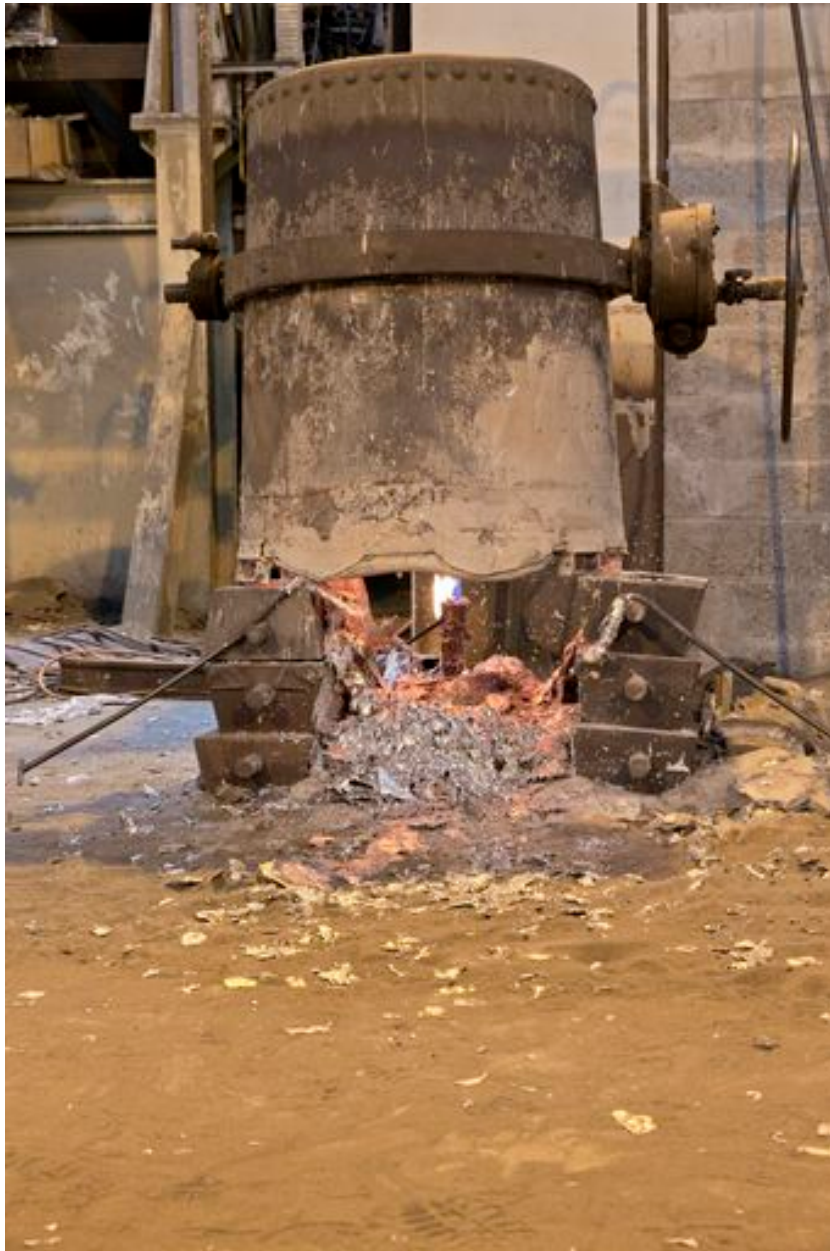
Poche de coulée en cours de chauffage.
