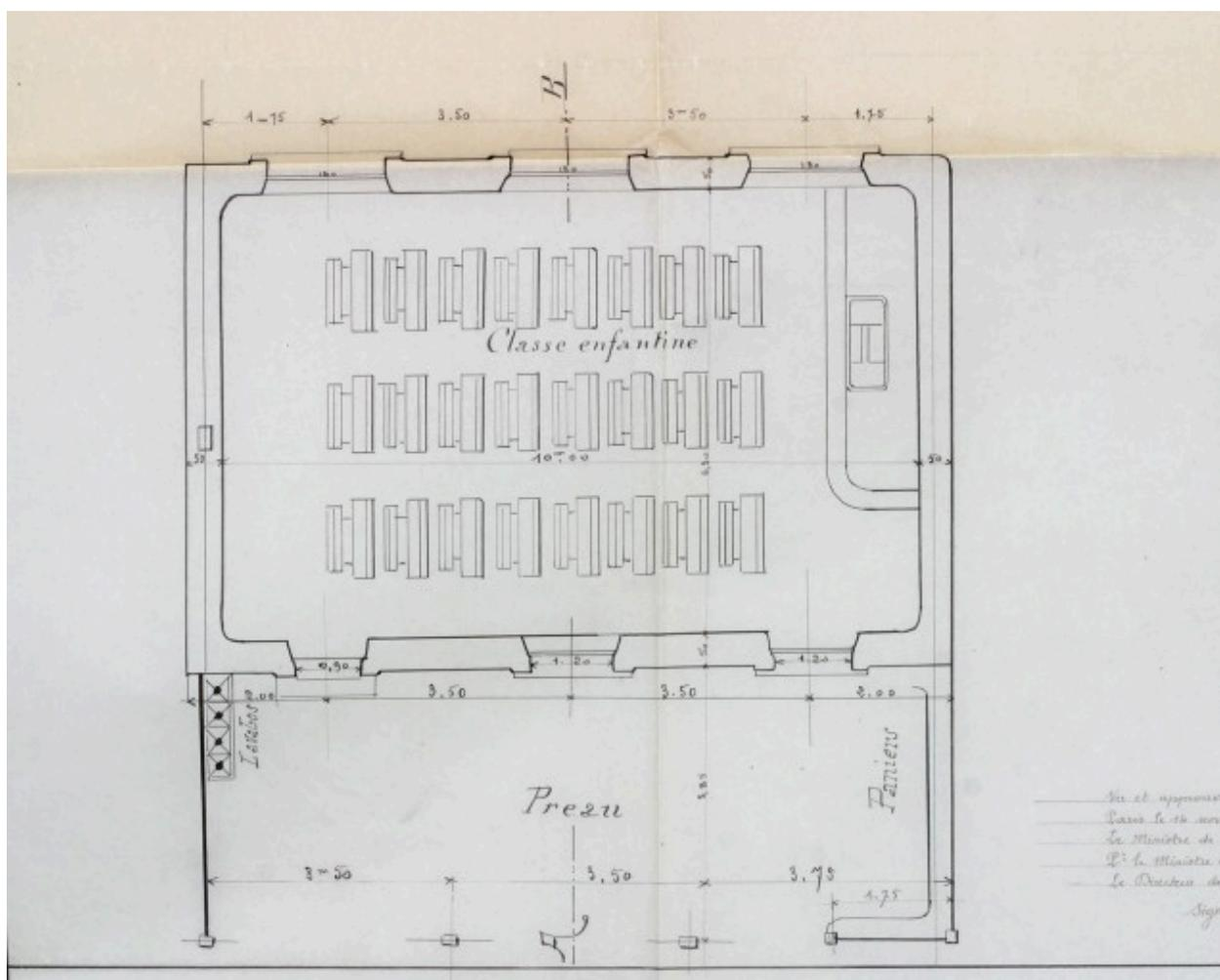
Construction d'une classe mixte, de water-closets et de préaux pour l'école primaire ; plans, élévations et coupes de la classe et du préau. Détail : plan au sol.
