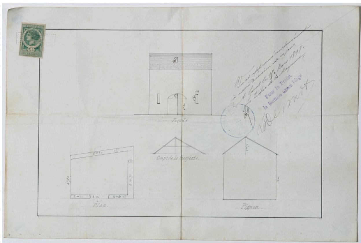
Projet (réalisé) d'un bâtiment de service, 1898 : plan, façade , pignon, coupe de la charpente.
