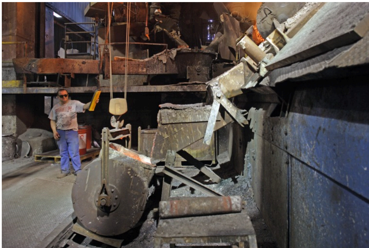
Le poste de coulée.
