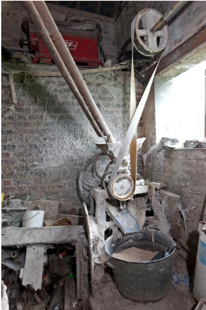
Laiterie 1 : détail de la transmission avec aplatisseur.
