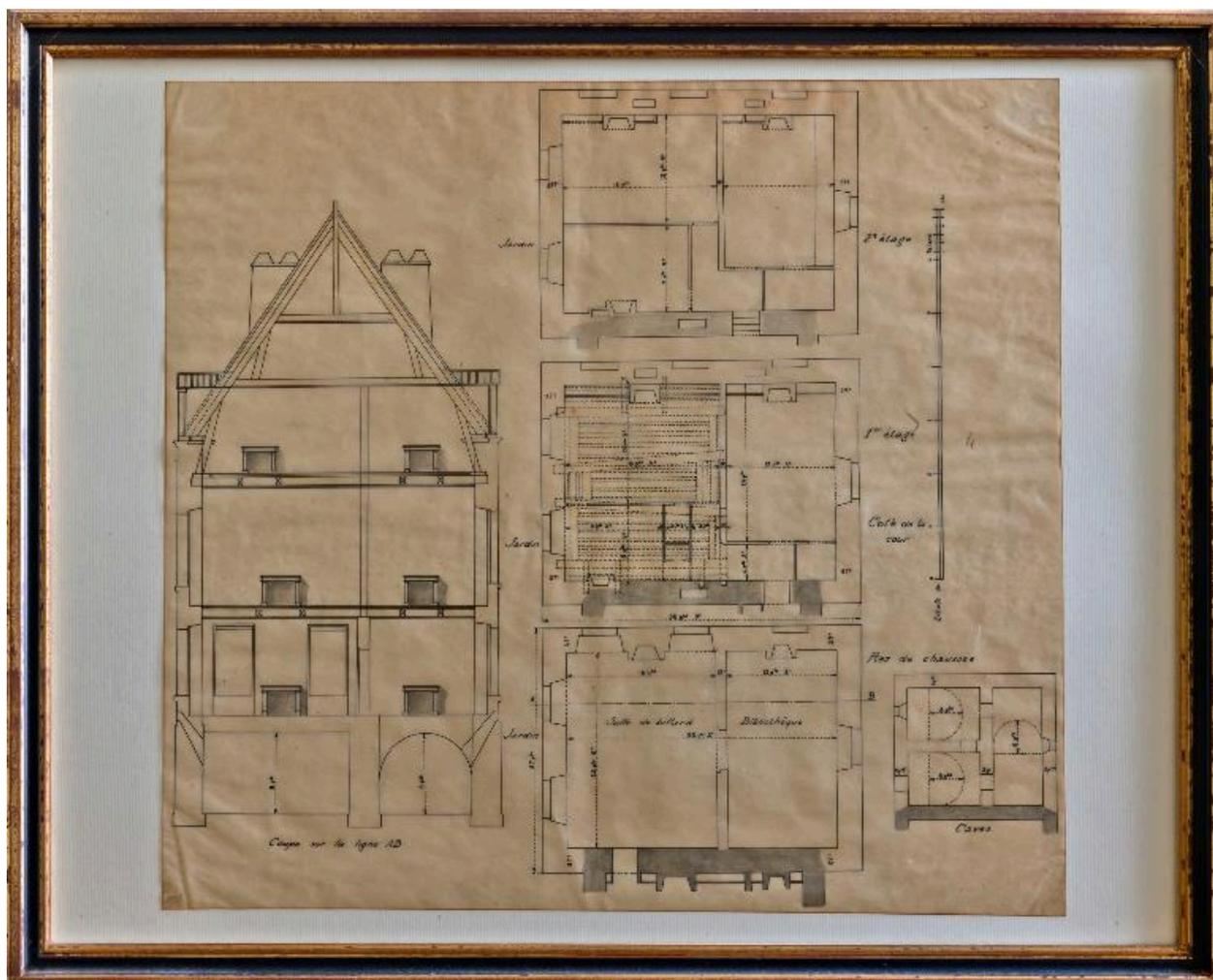
Projet (non définitif) de rénovation du château de la Porte : coupe et plans du sous-sol, du rez-de-chaussée, du premier étage et du second étage de la partie ajoutée (pavillon nord-ouest).
