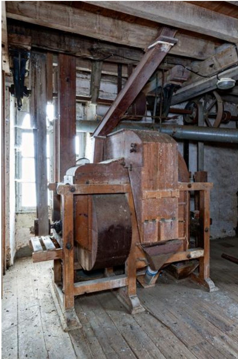
Deuxième étage, partie sud-est : le nettoyage à blé vu depuis l'ouest.
