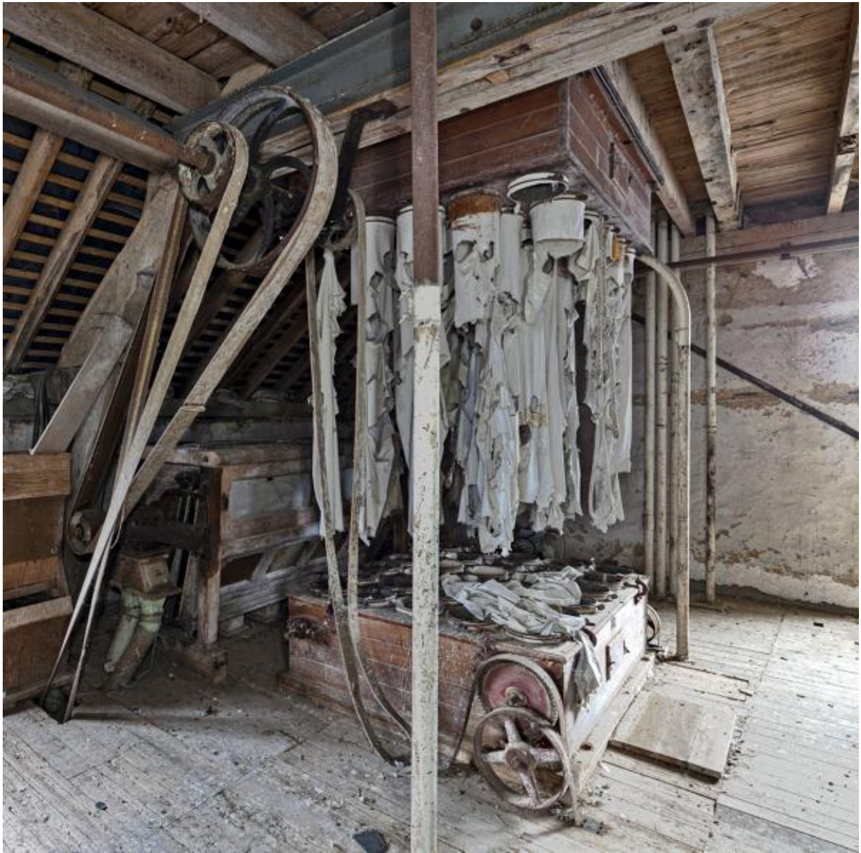
Étage en surcroît, partie nord-ouest vue depuis le sud-est : le filtre à air et la bluterie à son.
