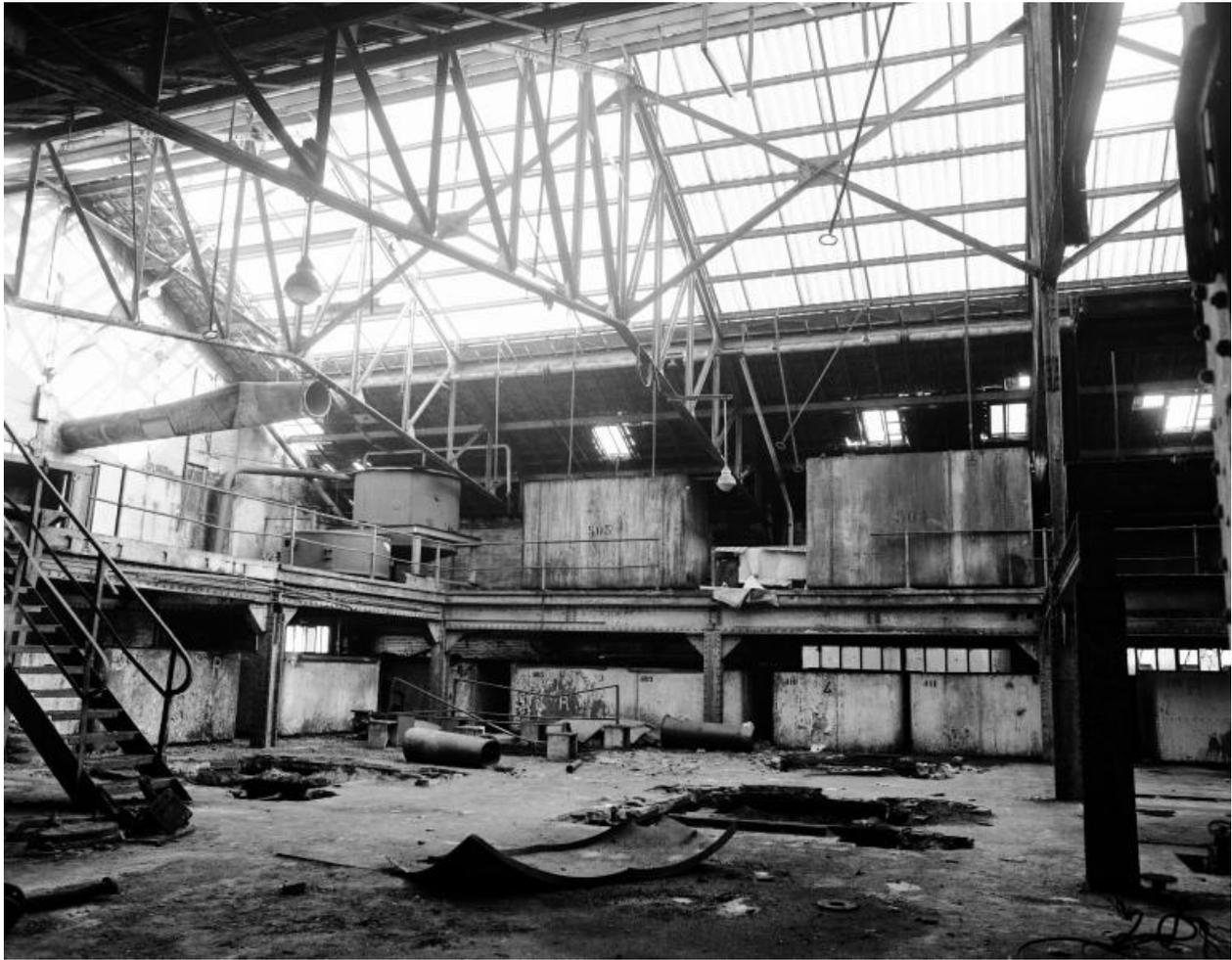
Nouvelle usine. Bâtiment non localisé. Dernier étage. Atelier de cuite avec bacs de stockage des sirops en place.
