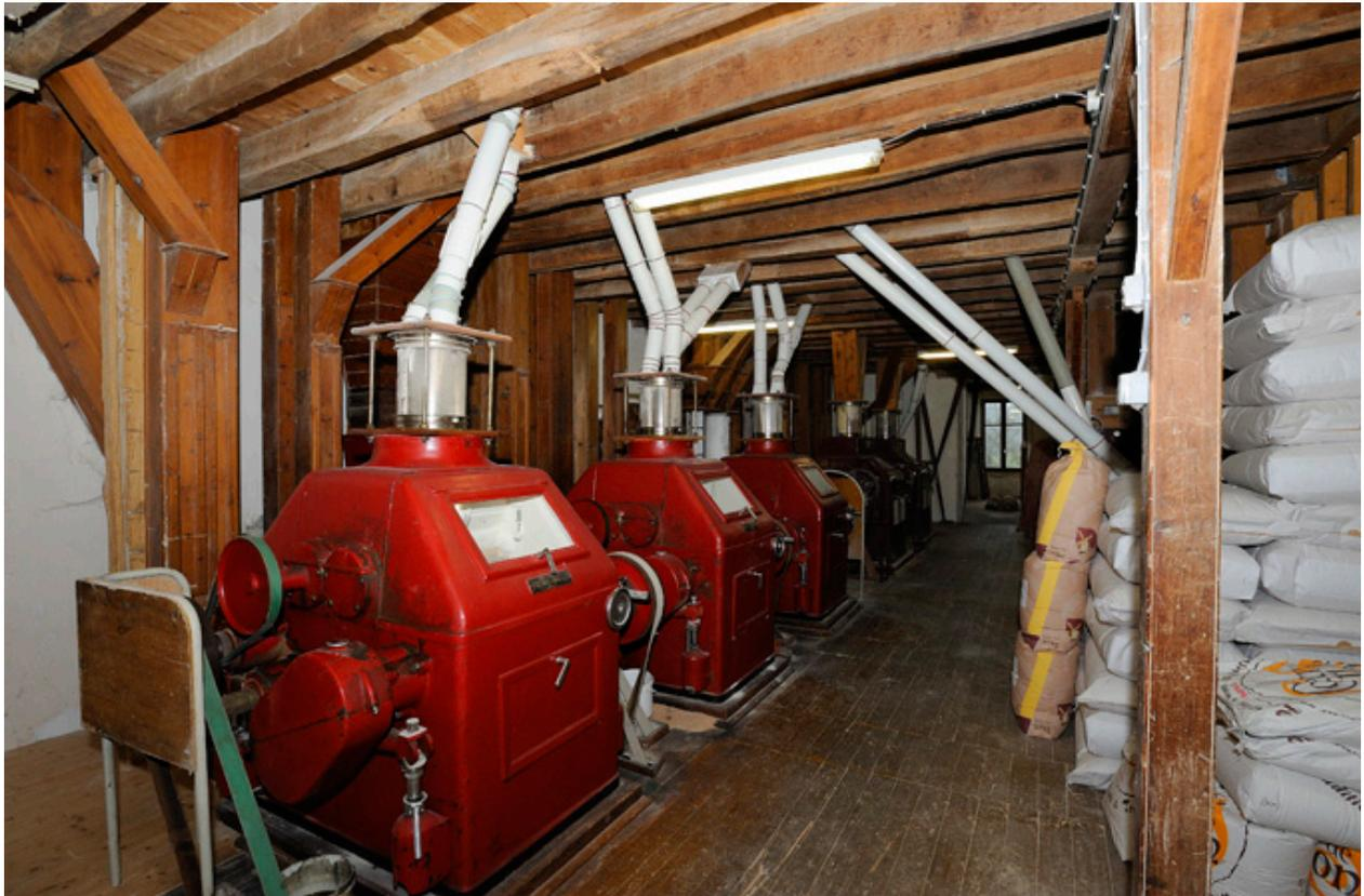
Série de broyeurs, qui écrasent la mouture, grâce à différentes tailles de cylindres cannelés.
