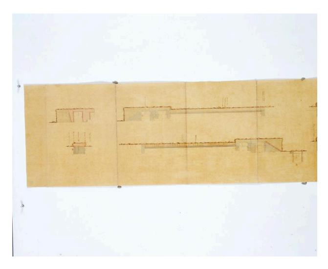
Projet de reconstruction du barrage : élévations du barrage et du pertuis, coupe de l'écluse.
