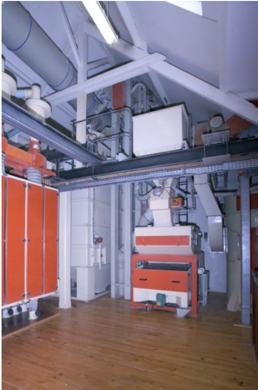
Minoterie, comble : le nettoyeur à blé.
