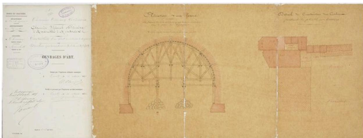
Élévation de la structure en bois nécessaire à la construction d'une arche du pont et détail de construction des corbeaux.
