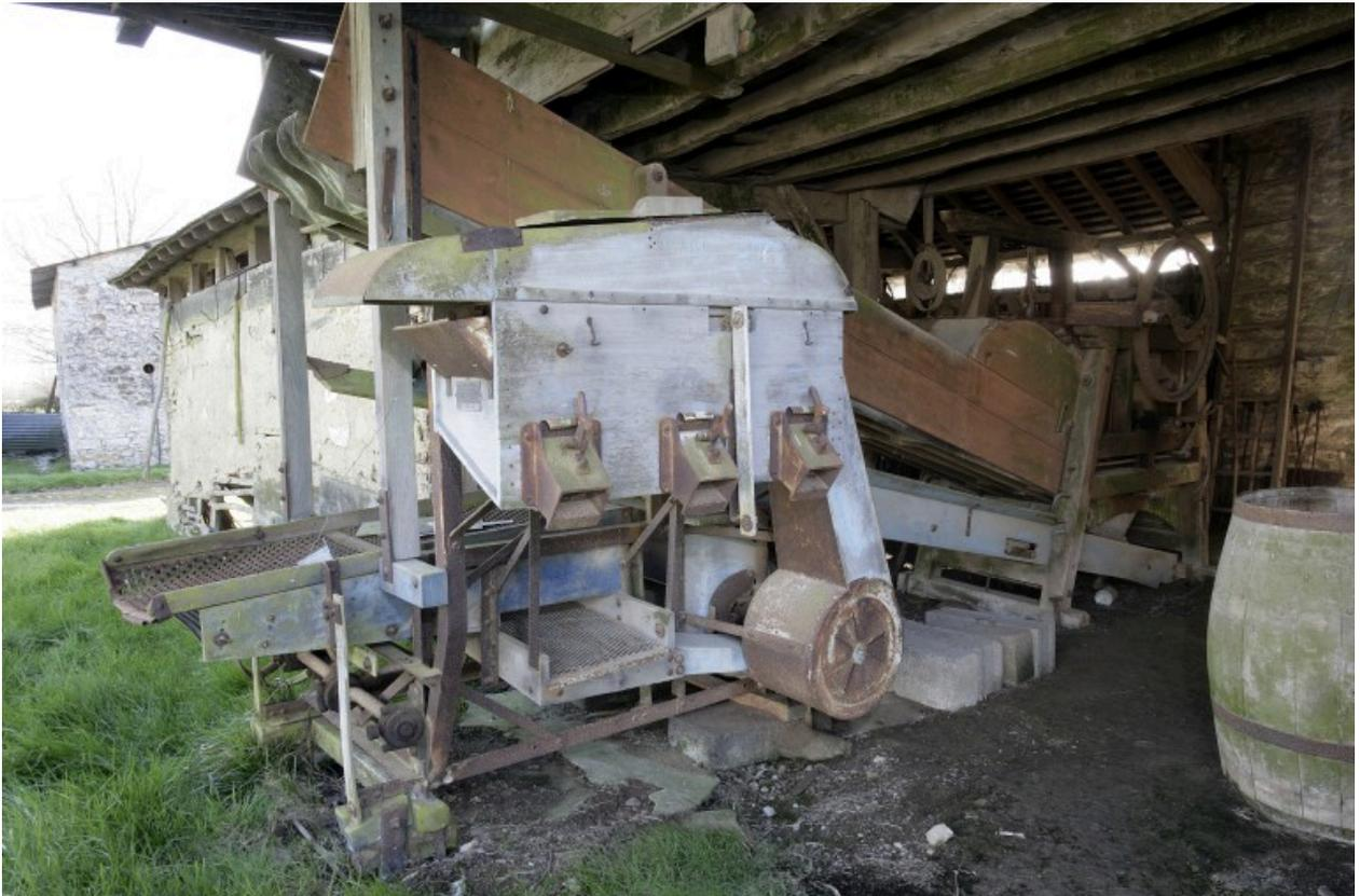
Vue antérieure gauche : au premier plan, la vannette avec ses trois ensacheurs ; derrière, le secoue-paille, le tapis roulant à grains et, au bout, la grille et le premier van. .
