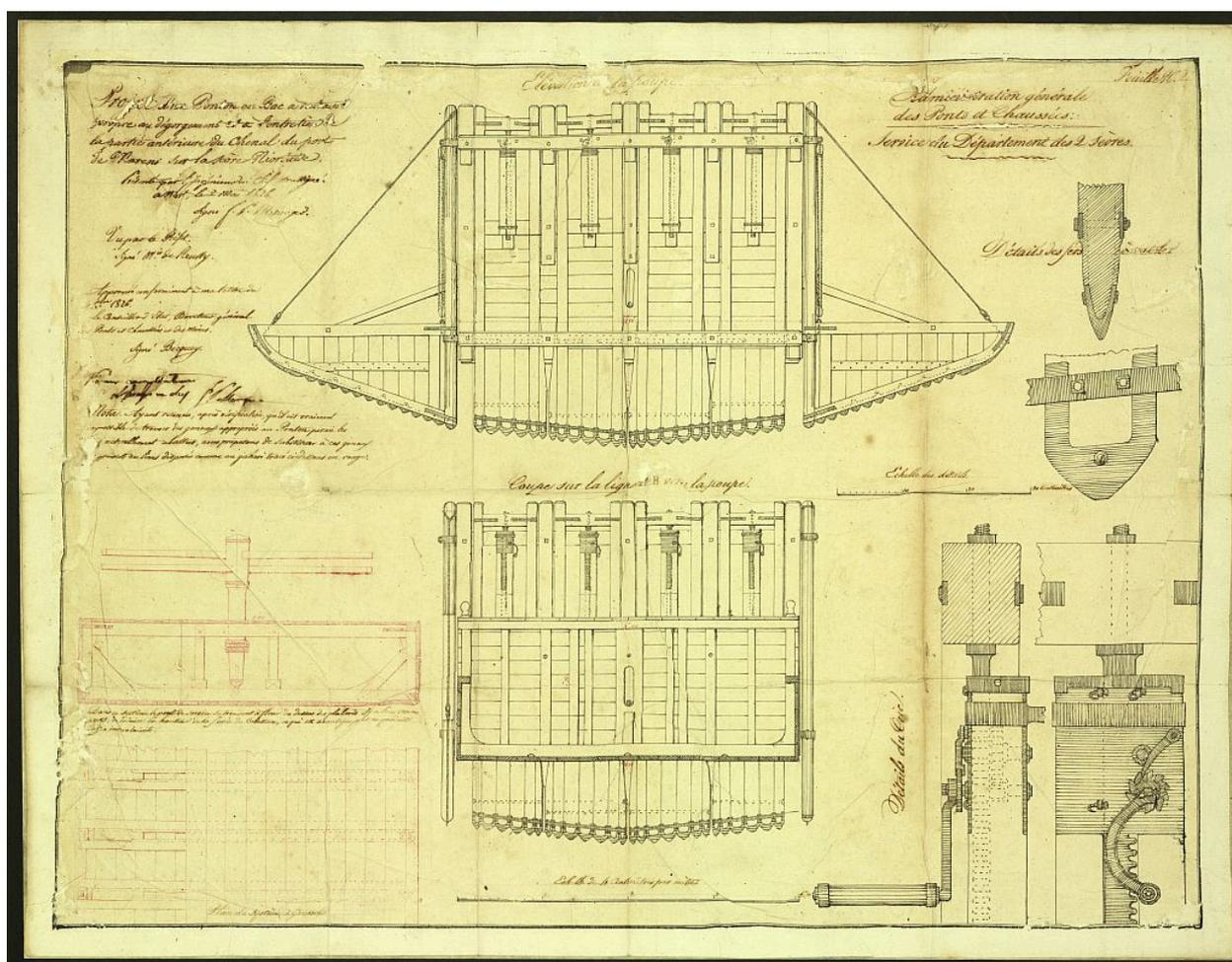
Projet d'un ponton ou bac à râteau propre au dégorgeement et à l'entretien de la partie antérieure du chenal du port de Marans, par Mesnager, 2 mai 1826 : élévation de la poupe, coupe et détails.
