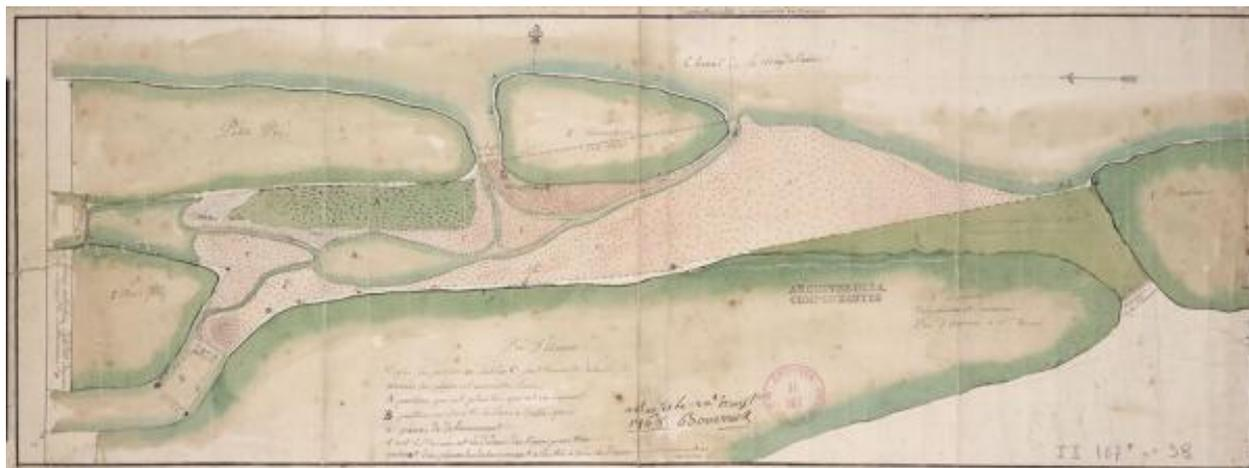
Plan des atterrissements provoqués entre les îles situées en amont de la Chaussée. La lettre C indique les parties couvertes aux marées de pleine et de nouvelle lune, la lettre A les parties plantées, la lettre B les parties en eau à marée basse, par Bonvoux. Dessin aquarellé, 62 x 23,5 cm, 20 août 1768
