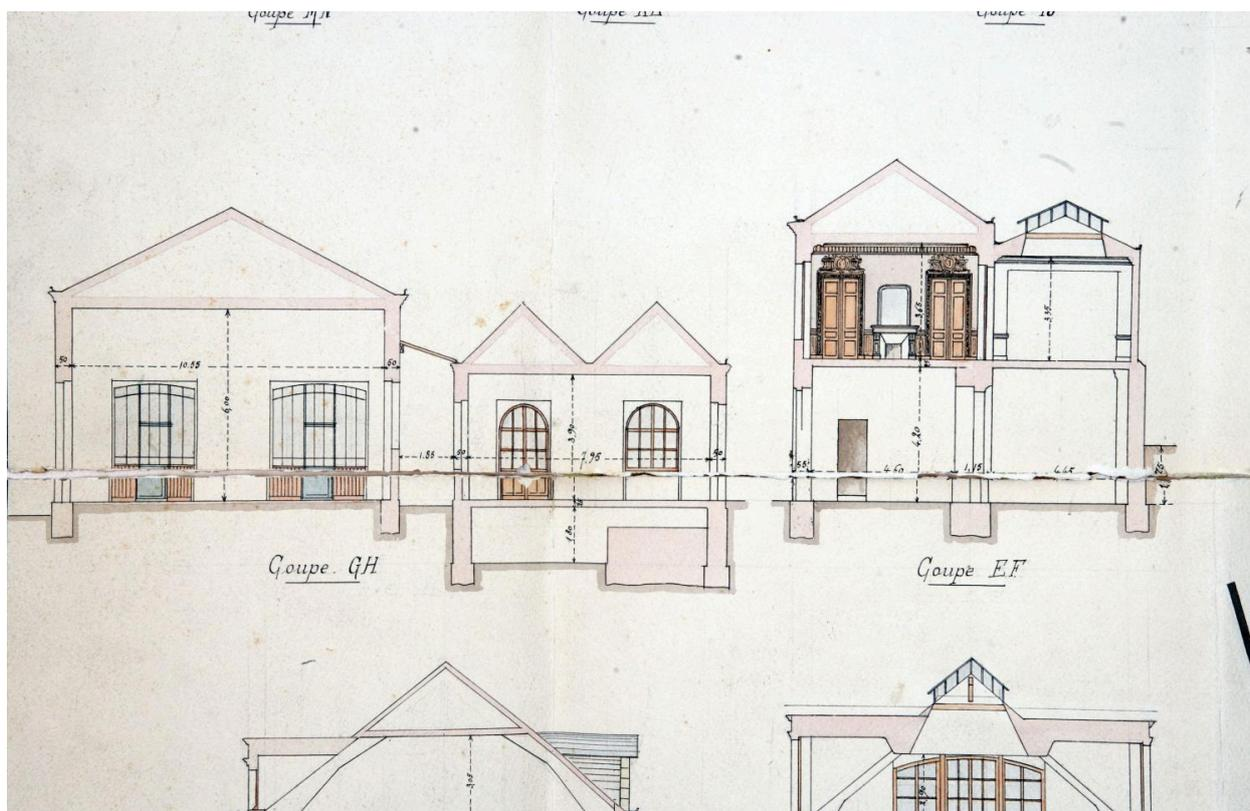
Usine Hamard : coupe longitudinale sur le bâtiment des machines dans la cour et coupe transversale sur le bâtiment d'entrée (porche, conciergerie et appartement) dans l'angle sud-ouest de la cour. Extrait d'un document général de l'usine, dessin, 1906.
