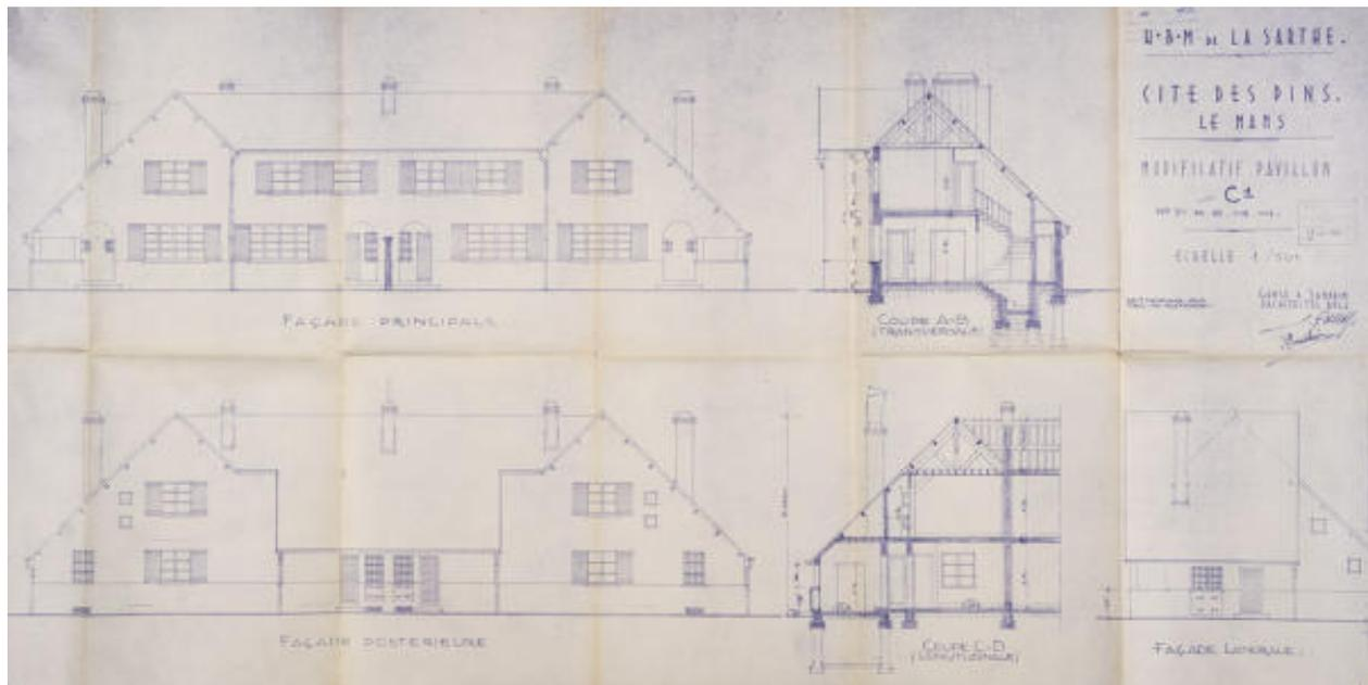
Plan, coupe et élévation pour pavillons quadruples.
