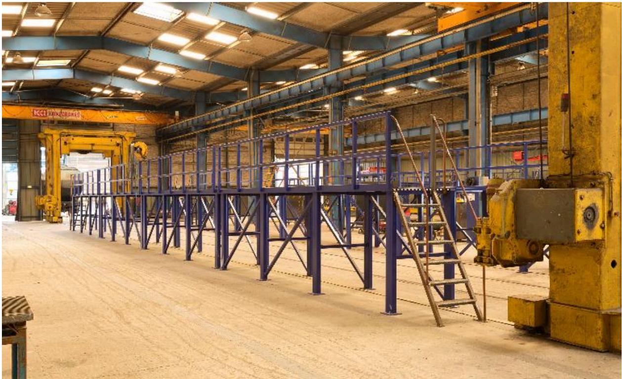
Intérieur de l'atelier d'assemblage, estrade pour le montage des porte-autos.
