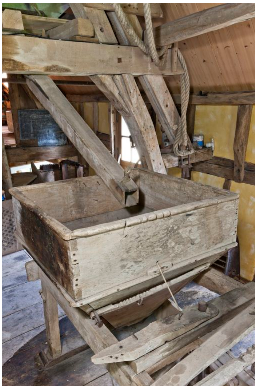
Détail de la trémie avec son anche
