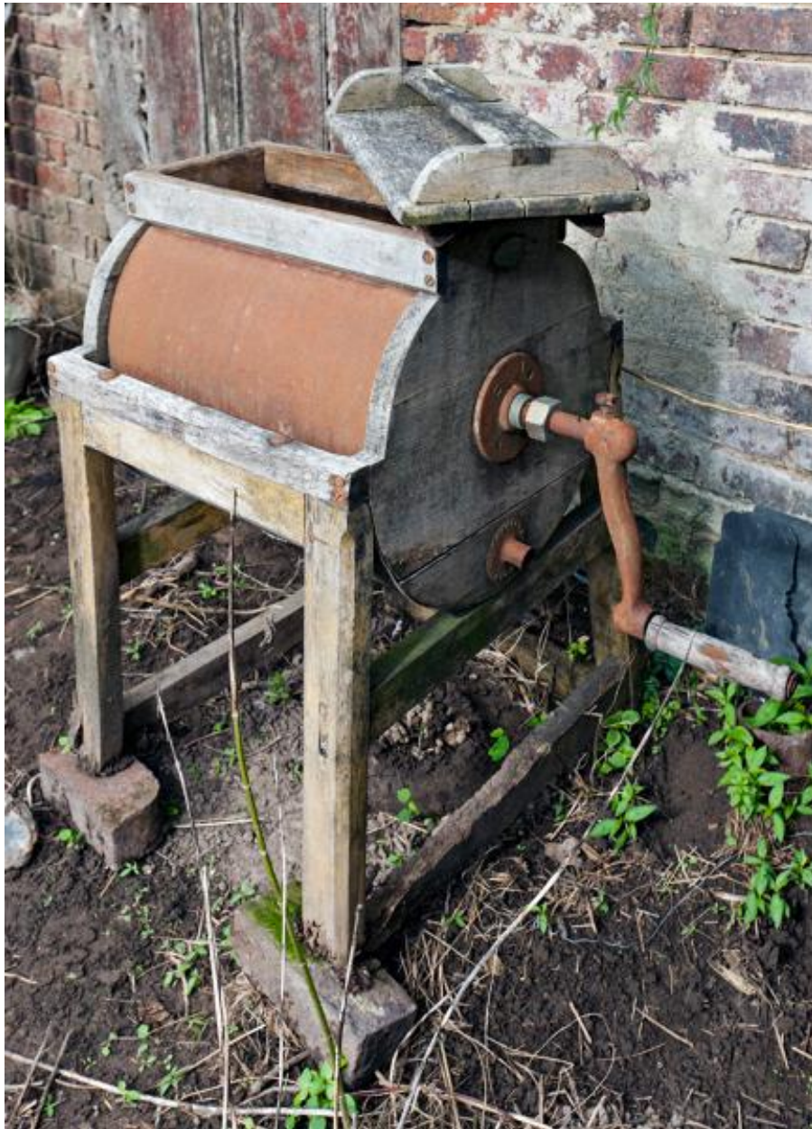
Laiterie 2 : baratte malaxeuse. Inscriptions : La Merveilleuse Système Guéry n°6528 Brevets SCDG Marque déposée.
