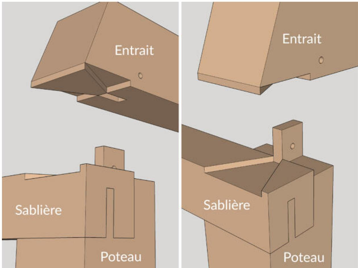
Détail de l'assemblage de la structure à poteaux porteurs.
