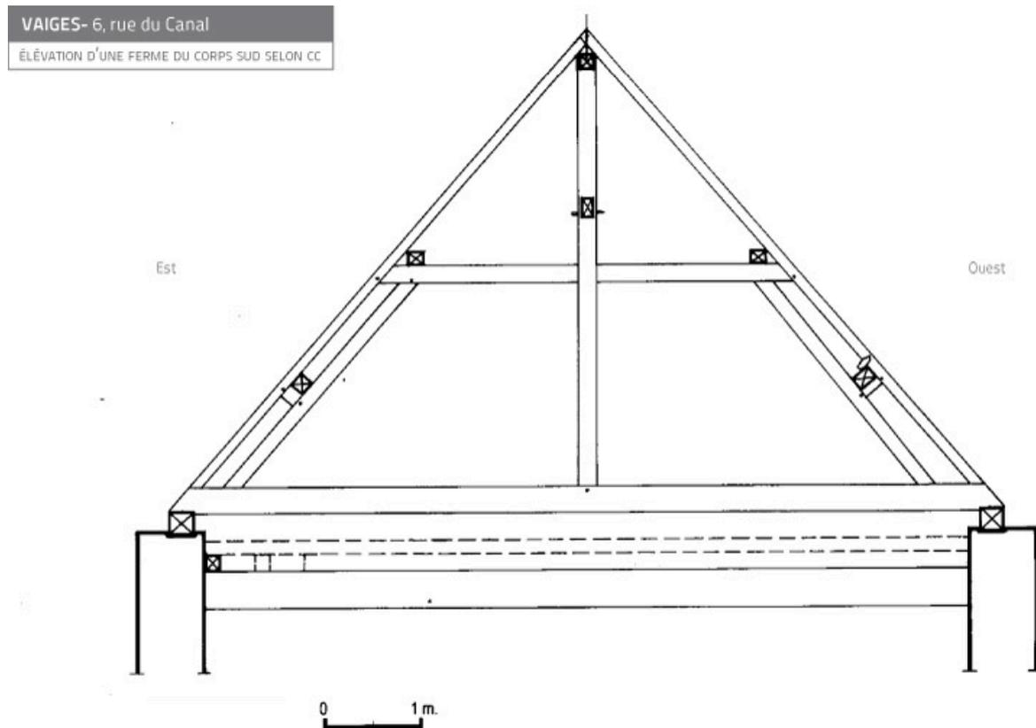
Corps de bâtiment sud : coupe transversale d'une ferme de la charpente.
