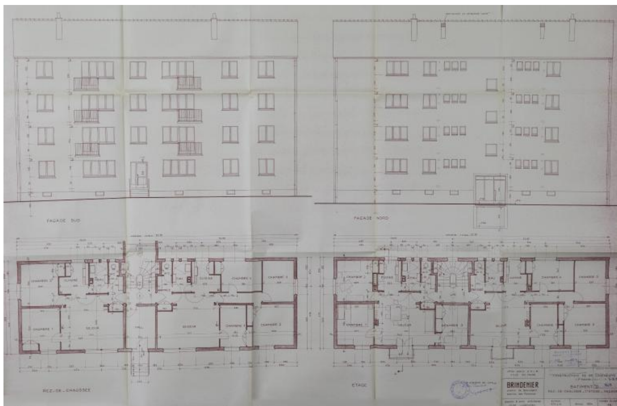
Elévation du bâtiment D et plan du rez-de-chaussée et du 1er étage, 1954.
