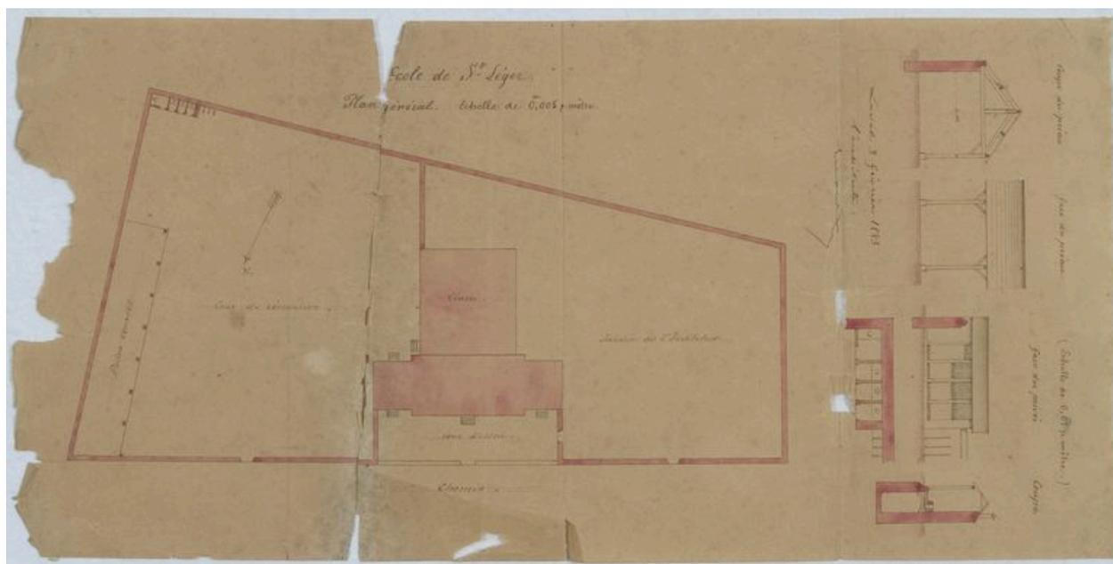
Projet pour l'école de garçons : plan d'ensemble ; coupe et élévation du préau ; plan, coupe et élévation des toilettes. Dessin de l'architecte Eugène Hawke, 1883.
