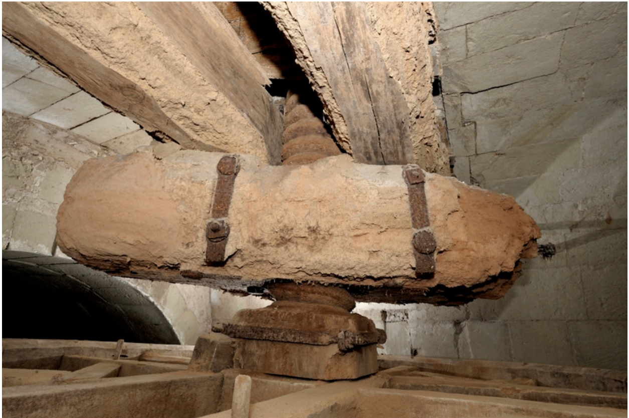
Pressoir : détail de la vis.
