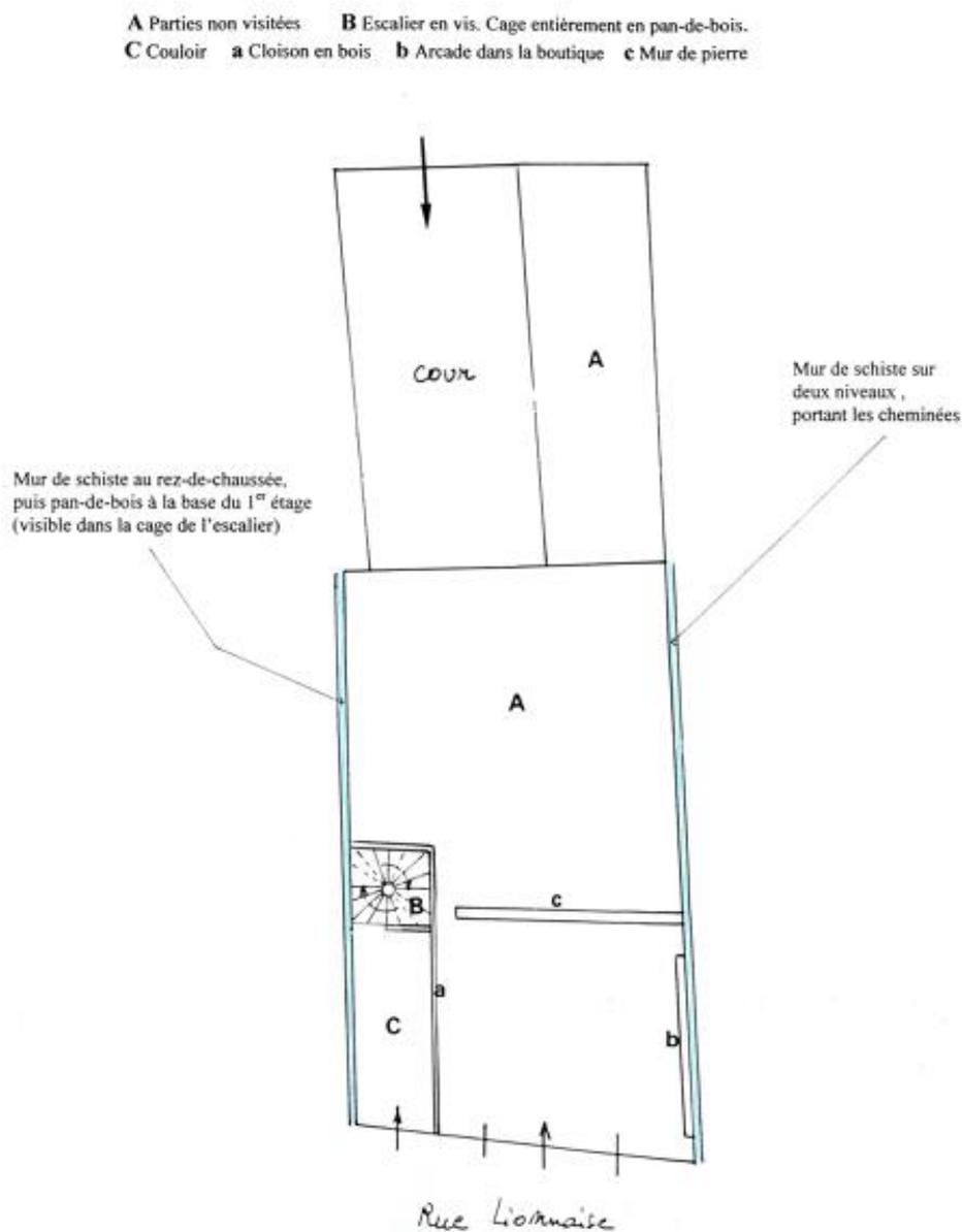
Plan schématique du rez-de-chaussée.
