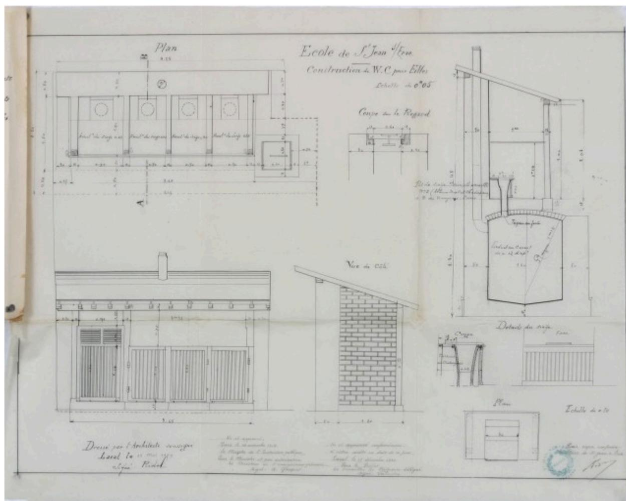
Construction d'une classe mixte, de water-closets et de préaux pour l'école primaire ; plan, élévations et coupes des WC pour filles.
