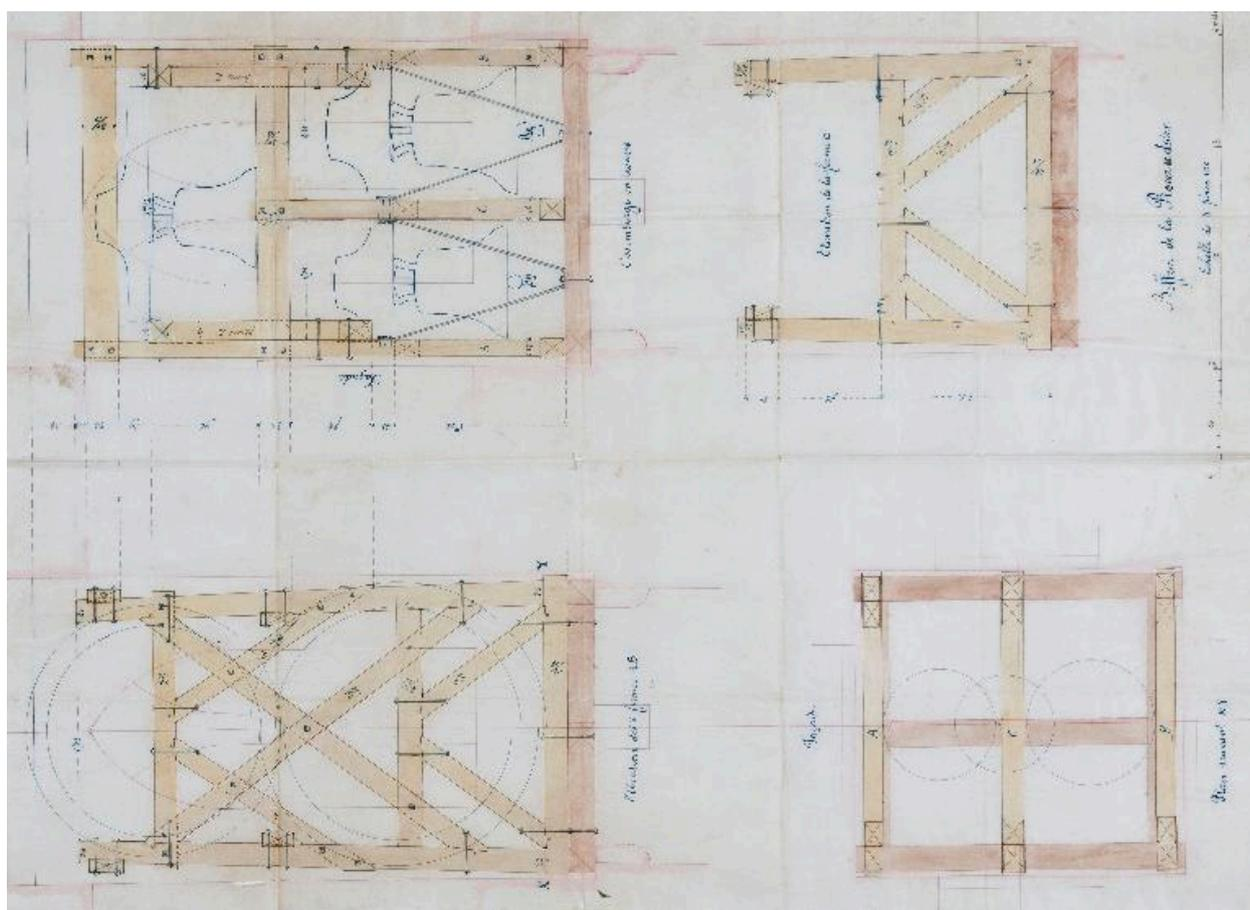
Projet de réaménagement du beffroi en vue de l'installation d'une troisième cloche (non réalisé) : plan et coupes.
