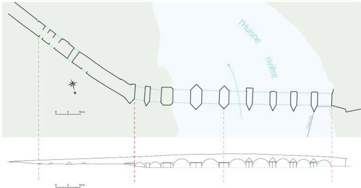
Le plan du pont et élévation de la face nord.
