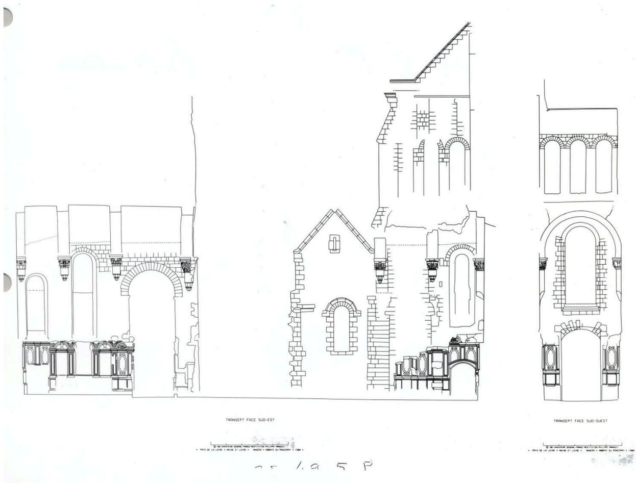
Abbatiale, transept : élévations intérieures est et sud. Relevé photogrammétrique
