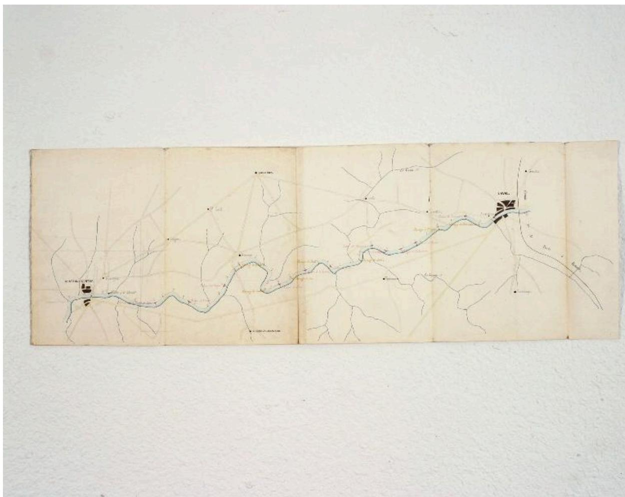
Projet de canalisation de la Mayenne entre Laval et Château-Gontier, 1865. En foncé, le nom des chaussées dont la destruction est prévue ; en clair, celui des barrages qui doivent être reconstruits et dotés d'une écluse (l'écluse est alors figurée par un petit trait). La réédification de Porte Neuve, finalement détruit, est encore envisagée.
